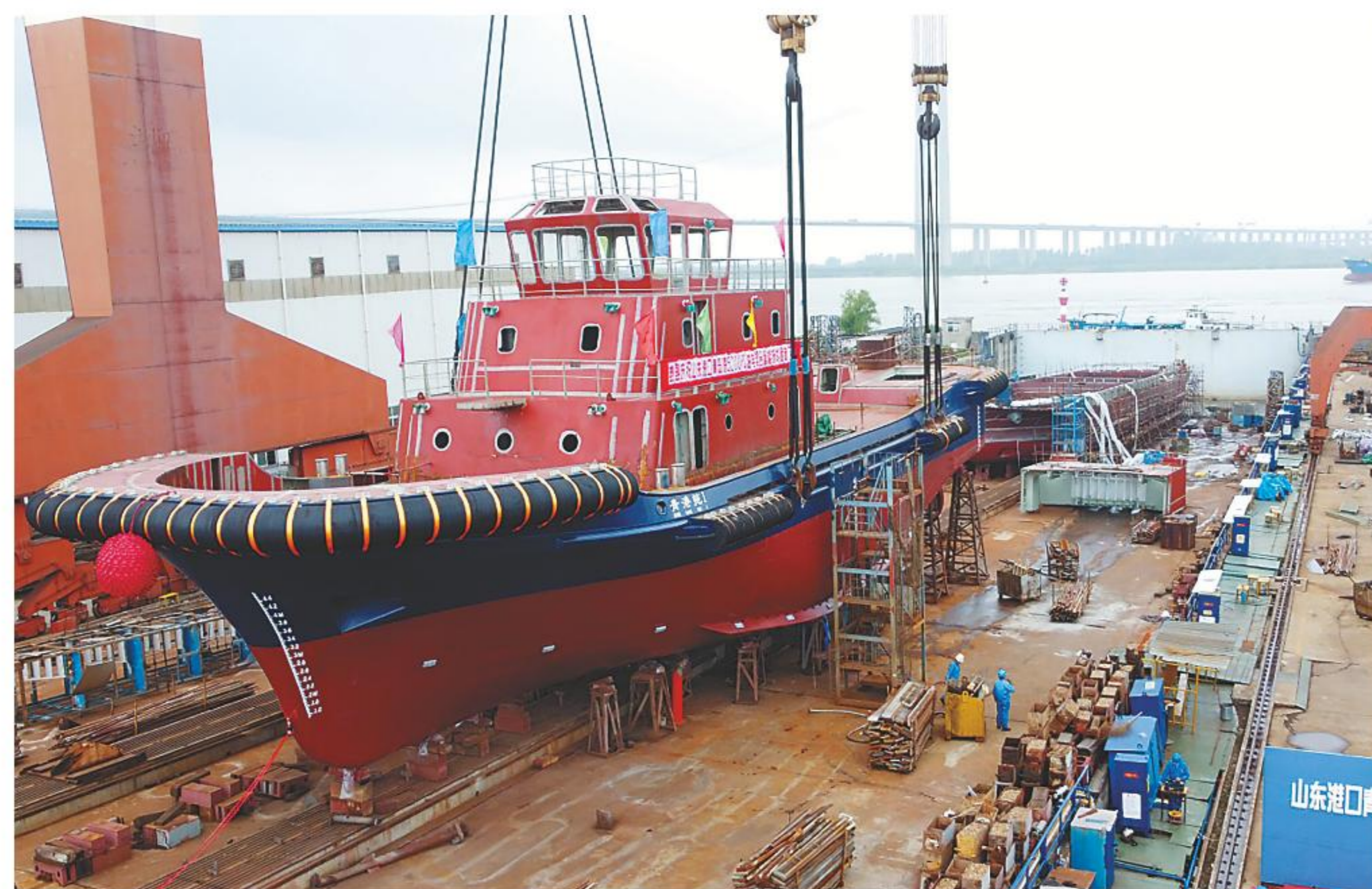
7月18日，中国第一艘采用油电双驱动混合动力推进方式的3824kW全回转拖船——“青港拖1”在镇江高新区顺利下水。该船是镇江船厂对多功能全回转拖船这一中国单项冠军产品实施绿色、环保、低碳技术升级开发的系列产品之一。摄 文朱管
