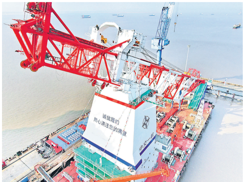
▲全球首艘140米级打桩船“一航津桩”日前在启东交付，创下桩架最高、吊桩能力最大、施打桩长最长、抗风浪能力最强等多项世界纪录。交付后，该船将主要用于大型桩基施工、群桩式基础、风电导管架桩、风电单桩等施工，在大型港口、跨海大桥、海上风电、人工岛等建设中发挥作用。
