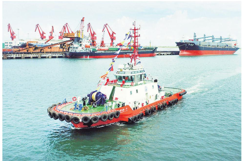
16日，中国首艘纯电动拖轮——“云港拖一号”在连云港投入运行。该拖轮采用磷酸铁锂电池组作为动力源，能够达到4000马力常规拖轮使用效果，可完全替代传统大功率燃油拖轮，实现大气污染物零排放，填补了中国大功率绿色低碳港口作业拖轮的空白。 摄 王健民 尹靓
